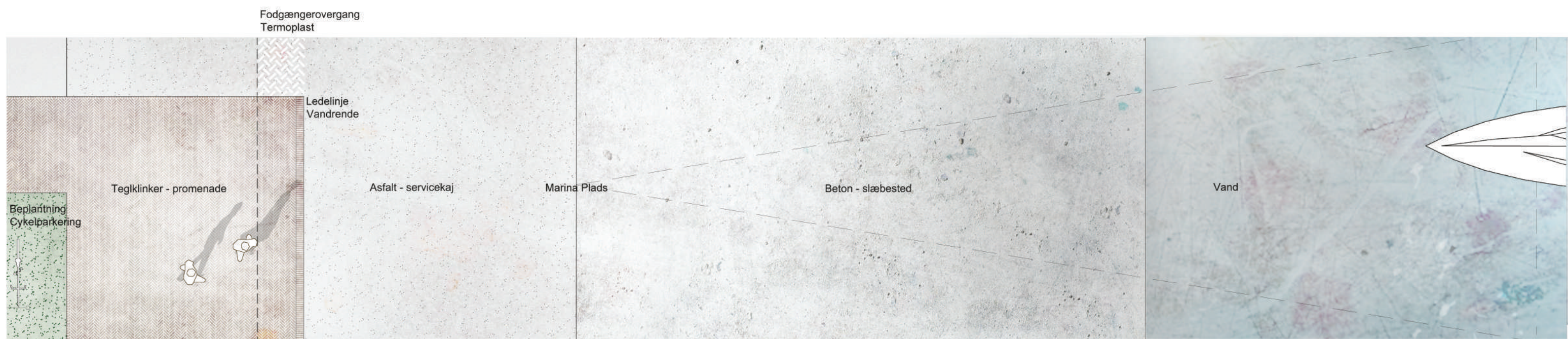
+ Udsnit 05 1:100 Snit og plan af slæbested ved Marianpladsen. Pladsens overflade er asfaltbeton, og slæbestedet udføres i beton.
